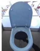
PRESSALIT WC-Sitz mit Deckel, Modell "Magnum", Art. Nr. 104 aus durchgefärbtem Duroplast mit B33 Festscharnieren aus V2A-Edelstahl - Scharnierabstand: 155 mm - Belastbarkeit - Sitzring 240 kg - für V&B Magnum Keramik
