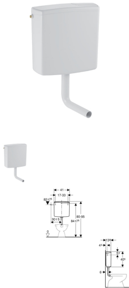
Geberit AP-Spülkasten AP140, tiefhängend, mit 2-Mengen-Spülung
